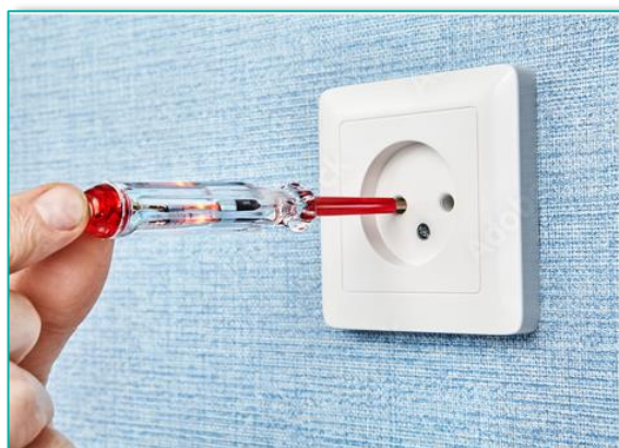
Figura 6: El buscapolo siempre encenderá una luz interior cuando haga contacto con la fase de la instalación [1].
