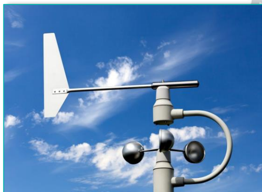
Figura 6: Anemómetro de cazoletas y veleta en lo alto de un mástil anemométrico [9].
